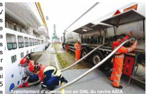
Branchement d'alimentation en GNL du navire AIDA
